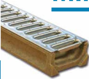
Linienentwässerungsrinne MINIKIT: Außenbreite 120 mm; Innenbreite 98 mm und Gesamthöhe 50 mm. Befestigungssystem mit "klick", ohne Schrauben.
