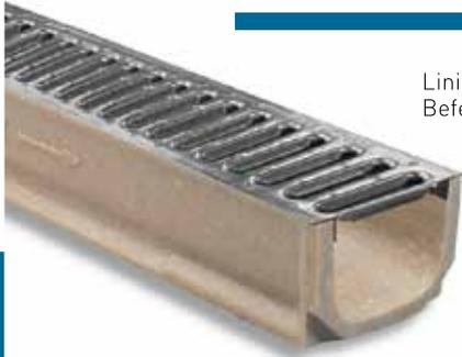
Linienentwässerungsrinne EUROKIT: Außenbreite 120 mm; Innenbreite 98 mm und Gesamthöhe 85 mm. Befestigungssystem mit "click", ohne Schrauben.
