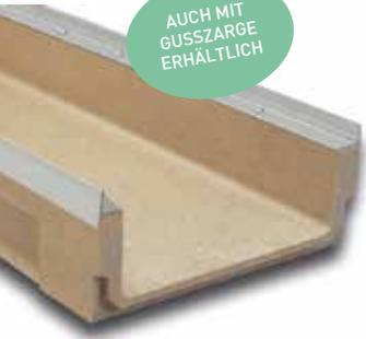
Linienentwässerungsrinne SM350F: Außenbreite 360 mm; Innenbreite 300 mm und Gesamthöhe 150 mm. Sichere Befestigung mit acht Schrauben pro laufendem Meter; Kantenschutz aus verzinktem Stahl\*.
