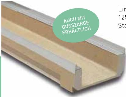
Linienentwässerungsrinne SM250F: Außenbreite 262 mm; Innenbreite 200 mm und Gesamthöhe 125 mm. Sichere Befestigung mit acht Schrauben pro laufendem Meter; Kantenschutz aus verzinktem Stahl\*.
