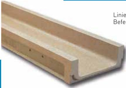
Linienentwässerungsrinne M200: Außenbreite 260 mm; Innenbreite 200 mm und Gesamthöhe 100 mm. Befestigungssystem mit 2 Schrauben pro laufendem Meter.
