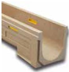
Linienentwässerungsrinne U150: Außenbreite 204 mm; Innenbreite 150 mm und Gesamthöhe zwischen 200 und 300 mm. Befestigung mit Knebel und Schrauben. Stufengefälle möglich.
