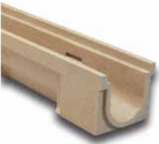
Linienentwässerungsrinne D100: Außenbreite 155 mm; Innenbreite 100 mm und Gesamthöhe zwischen 140 und 235 mm. Stufengefälle möglich. Befestigung mit Knebel und Schrauben. Mit Schutzkanten aus Polymerbeton.
