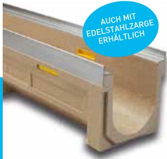
Linienentwässerungsrinne U150K: Außenbreite 204 mm; Innenbreite 150 mm und Gesamthöhe zwischen 220 und 320 mm. Kantenschutz aus verzinktem Stahl\*. Befestigung mit Knebel und Schrauben. Stufengefälle möglich.
