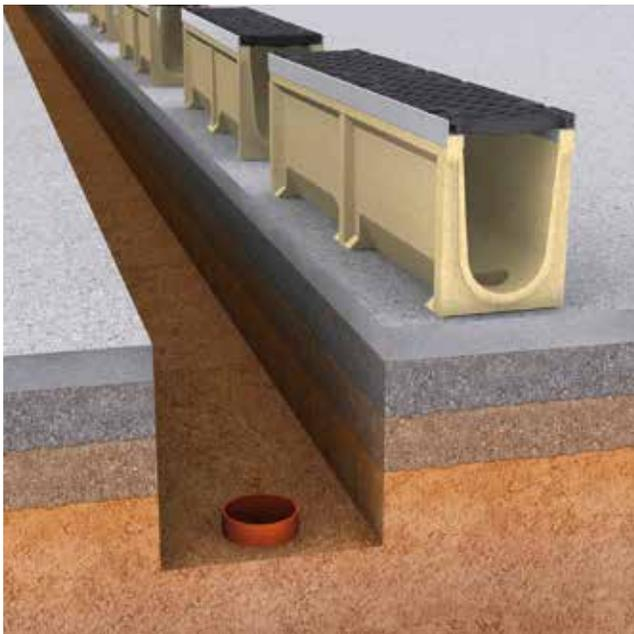
Die Verlegung der Entwässerungsrinnen sollte am Ablaufpunkt oder am tiefsten Punkt des Rinnenstranges beginnen. Vor dem Gießen des Betonbettes für den Rinnenkörper sind zum Schutz vor Verformung des Kanals Holzleisten oder mit Folie geschützte Roste einzulegen.
