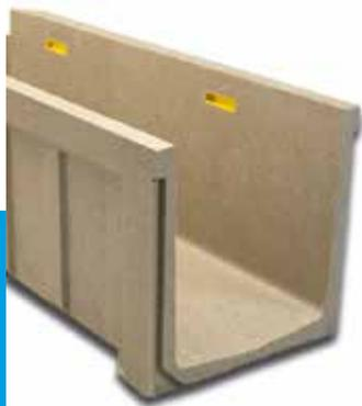
Linienentwässerungsrinne U250: Außenbreite 310 mm; Innenbreite 250 mm und Gesamthöhe 275 mm. Befestigung mit Knebel und Schrauben.
