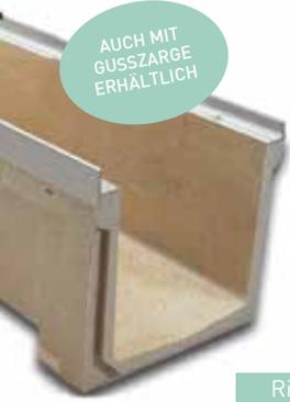
Linienentwässerungsrinne F250K: Außenbreite 312 mm; Innenbreite 250 mm und Gesamthöhe zwischen 300 und 450 mm. Sichere Befestigung mit acht Schrauben pro laufendem Meter; Kantenschutz aus verzinktem Stahl\*. Stufengefälle möglich.
