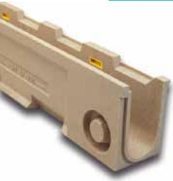
Linienentwässerungsrinne DP100.20: Außenbreite 155 mm; Innenbreite 100 mm und Gesamthöhe 235mm mit seitlichen Öffnungen für zusätzliche Wassersammlung. Befestigung mit Knebel und Schrauben. Schutzkanten aus Polymerbeton.
