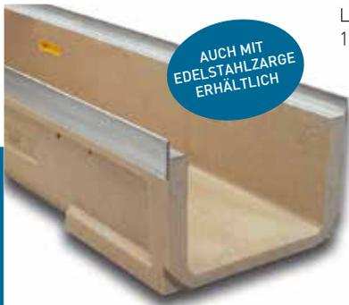
Linienentwässerungsrinne SELF250K: Außenbreite 260 mm; Innenbreite 200 mm und Gesamthöhe 180mm. Kantenschutz aus verzinktem Stahl. Befestigung mit Knebel und Schrauben.
