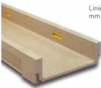
Linienentwässerungsrinne M300: Außenbreite 360 mm; Innenbreite 300 mm und Gesamthöhe 125 mm. Befestigung mit Knebel und Schrauben.
