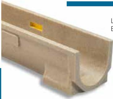
Linienentwässerungsrinne SELF: Außenbreite 130 mm; Innenbreite 100 mm und Gesamthöhe 115 mm. Befestigung mit Knebel und Schrauben.
