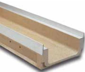
Linienentwässerungsrinne M200K: Außenbreite 260 mm; Innenbreite 200 mm und Gesamthöhe 125 mm. Kantenschutz aus verzinktem Stahl. Befestigungssystem mit 2 Schrauben pro laufendem Meter.
