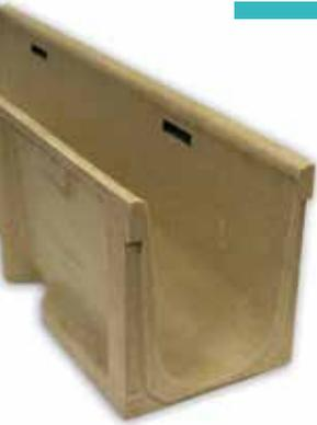
Linienentwässerungsrinne SU200: Außenbreite 250 mm; Innenbreite 200 mm und Gesamthöhe zwischen 240 und 340 mm. Befestigung mit Knebel und Schrauben. Stufengefälle möglich.
