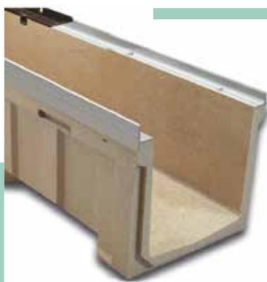
Linienentwässerungsrinne F250K: Außenbreite 312 mm; Innenbreite 250 mm und Gesamthöhe zwischen 150 und 650 mm. Sichere Befestigung mit acht Schrauben pro laufendem Meter; Kantenschutz aus verzinktem Stahl\*. Verschiedene Gefälle- Möglichkeiten: 2,5% Eigengefälle, Stufengefälle oder Mischgefälle.
