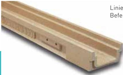
Linienentwässerungsrinne M100V: Außenbreite 155 mm; Innenbreite 100 mm und Gesamthöhe 80 mm. Befestigungssystem mit 2 Schrauben pro laufendem Meter.
