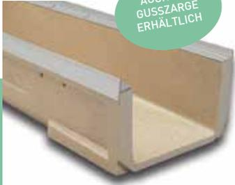
Linienentwässerungsrinne S300F: Außenbreite 312 mm; Innenbreite 250 mm und Gesamthöhe 210 mm. Sichere Befestigung mit acht Schrauben pro laufendem Meter; Kantenschutz aus verzinktem Stahl\*.
