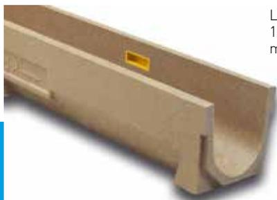
Linienentwässerungsrinne U100: Außenbreite 130 mm; Innenbreite 100 mm und Gesamthöhe zwischen 130 und 230 mm für 0.5% Gefällerrinnen und zwischen 130 und 280 mm für Stufengefälle. Befestigung mit Knebel und Schrauben.
