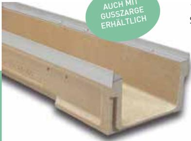
Linienentwässerungsrinne S200F: Außenbreite 204 mm; Innenbreite 150 mm und Gesamthöhe 162 mm. Sichere Befestigung mit acht Schrauben pro laufendem Meter; Kantenschutz aus verzinktem Stahl\*.
