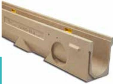
Linienentwässerungsrinne SU100: Außenbreite 130 mm; Innenbreite 100 mm und Gesamthöhe zwischen 180 und 230 mm. Befestigung mit Knebel und Schrauben. Stufengefälle möglich.
